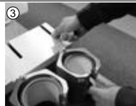
Dociskając kubek zamknąć prasę przez opuszczenie ramienia. Następuje odliczanie czasu wygrzewania. Koniec wygrzewania sygnalizowany jest dźwiękiem. Należy wówczas podnieść ramię i wyjąć kubek.
