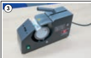
Dociskając kubek zamknąć prasę przez opuszczenie ramienia dociskowego. Następuje odliczanie czasu wygrzewania. Koniec wygrzewania sygnalizowany jest dźwiękiem. Należy wówczas podnieść ramię dociskowe i wyjąć kubek.
